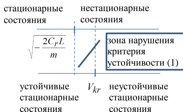
Рисунок 2 – Нарушение критерия устойчивости
