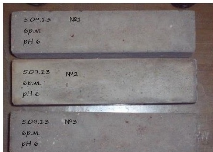
Рис. 8 – Бетонные образцы с водой, прошедшей магнитную обработку 6 раз с \text{pH} = 6 на 28 сутки
