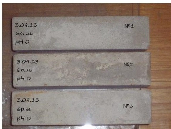
Рис. 9 – Бетонные образцы с водой, прошедшей магнитную обработку 6 раз с \text{pH} = 0 на 28 сутки.
