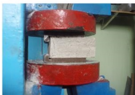
Рис. 11 – Бетонный образец с водой, прошедшей магнитную обработку 6 раз с pH = 6 на 28 сутки.
