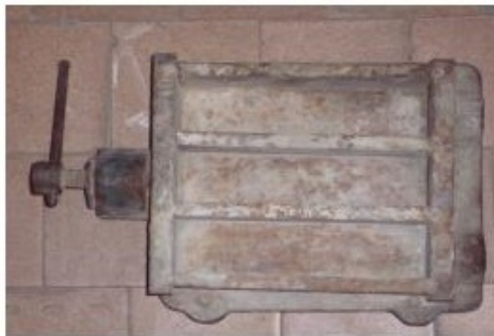
Рис. 6 - Форма для получения лабораторных бетонных образцов
