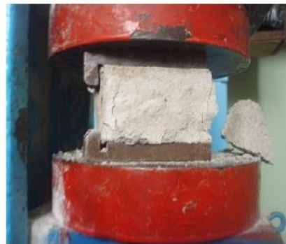
Рис. 10 – Бетонный образец с обычной водой с pH = 6 на 28 сутки.
