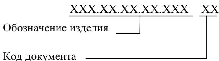
Рисунок 1 – Структура обозначения конструкторского документа
