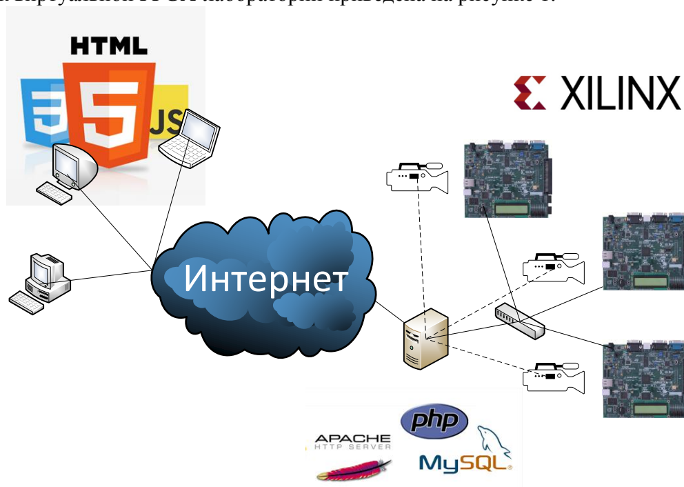
Рисунок 1 – Структура организации удаленного доступа к виртуальной FPGA-лаборатории
