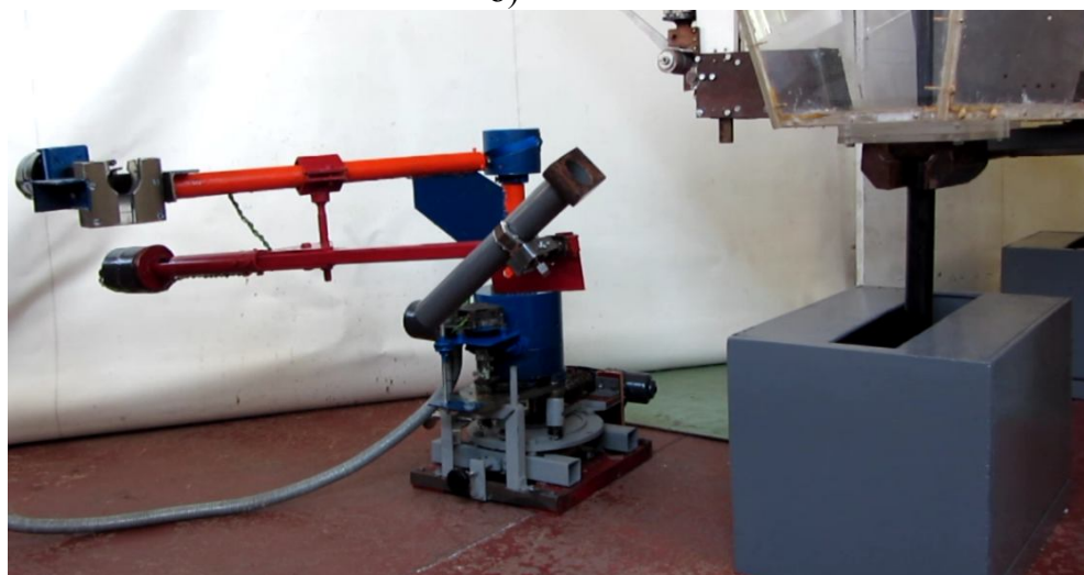
Рисунок 4 – Относительное положение звеньев физической модели манипулятора при уборке отработанного погружного стакана: в момент захвата сменяемого огнеупора (а); после его выведения из полости кристаллизатора (б) и отвода из рабочей зоны (в)
