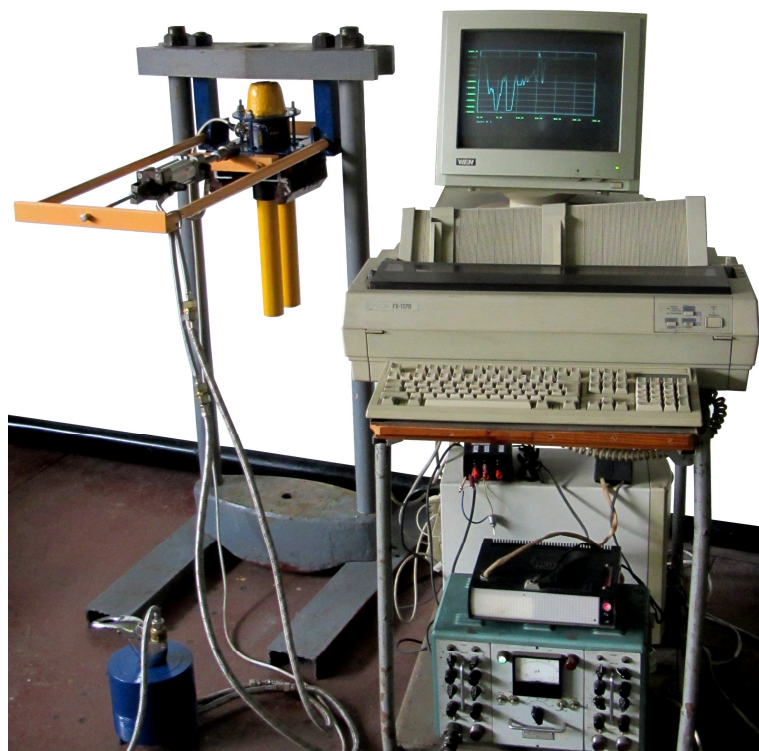
Рисунок 5 – Общий вид контрольно–измерительного комплекса и лабораторного образца устройства быстрой смены погружных стаканов
