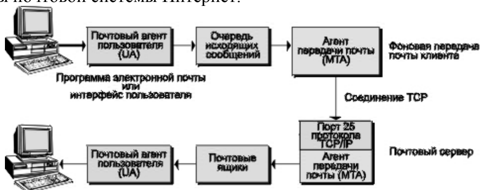
Рисунок 2.1 - компоненты почтовой системы
