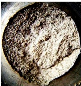
Рисунок 1 – Излом ушка петли после испытания на разрушение,  $\times 16$
