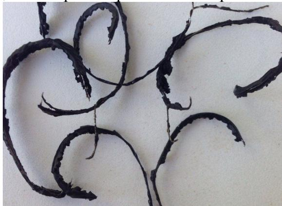
Рисунок 1 - Извлеченный из резины металлокорд, x1:1
