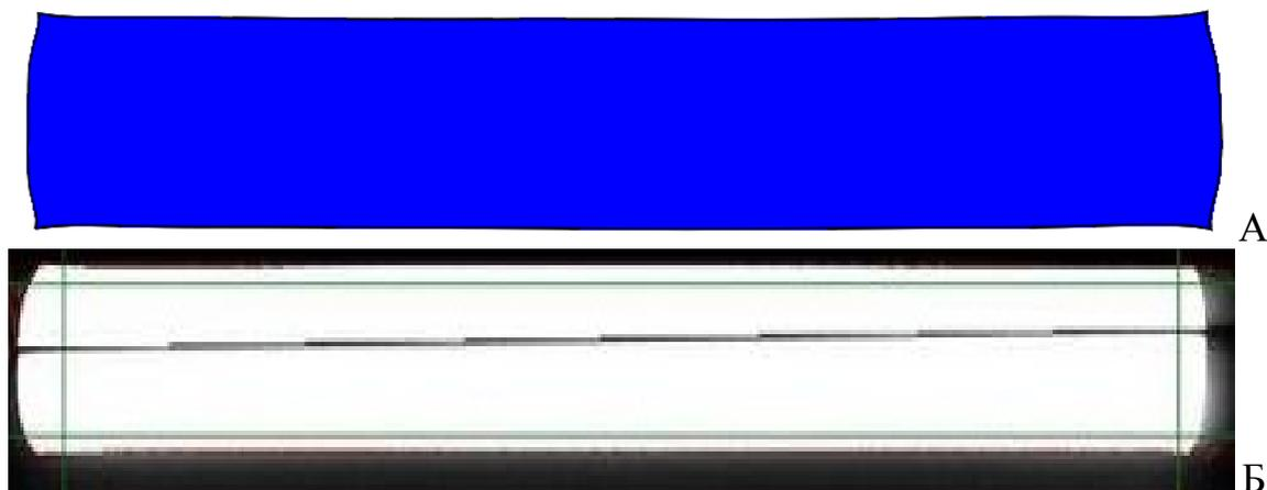
Рисунок 3 - Форма раската в плане в результате компьютерного моделирования (А) и действительная форма раската в плане (Б), полученная при прокатке листа  $40 \times 1500 \times 8500$  мм из слэба  $250 \times 1250 \times 1985$  мм
