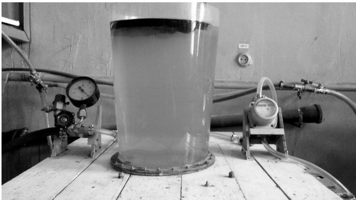
Рисунок 1 - Физическая модель сталеразливочного ковша
