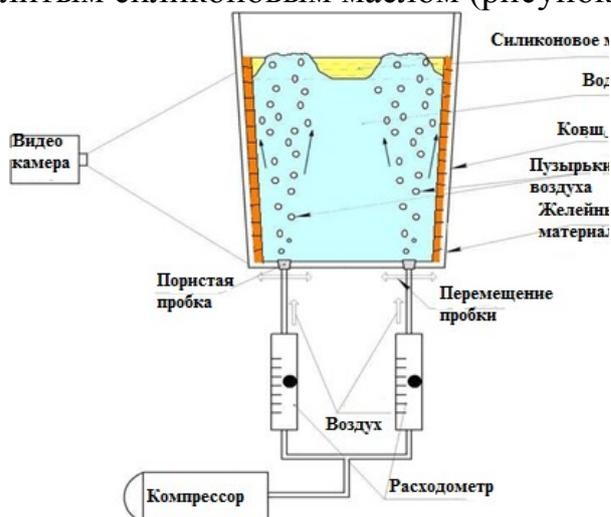
Рисунок – Схема модели для измерения износа футеровки
