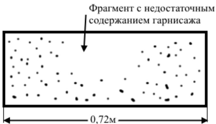
Рисунок - Неравномерность нанесения гарнисажа
