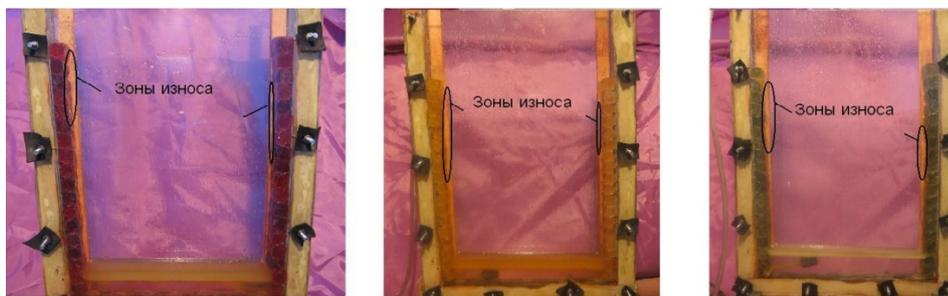
Рисунок 2 – Размыв футеровки при положении пробки на 0,6R
