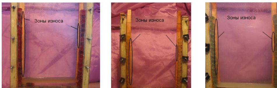
Рисунок 3 – Размыв футеровки при положении пробки на 0,75R
