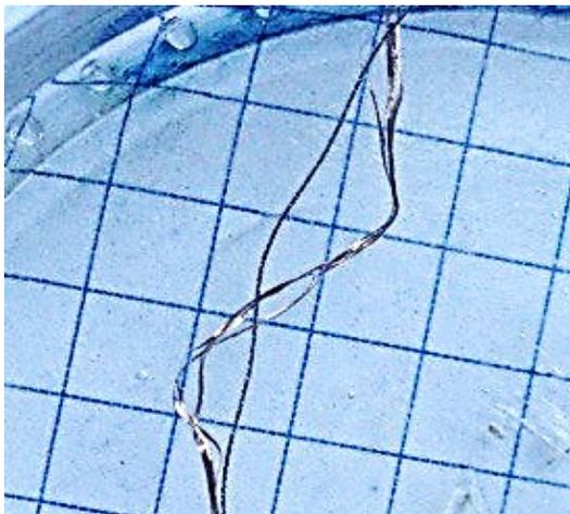
Рисунок 4 – Латунированная проволока после воздействия раствора  $H_2SO_4$  в течение 24 часов
