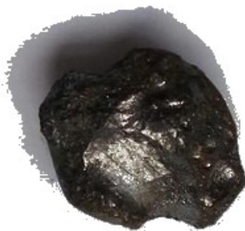
Рисунок 2 – Переплавленное губчатое железо
