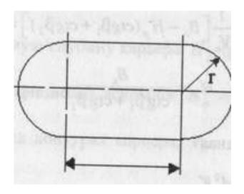
Периметр равен U = 2I +  $2\pi$ г, площадь поперечного сечения S =  $\pi$ г<sup>2</sup> + 2гI
