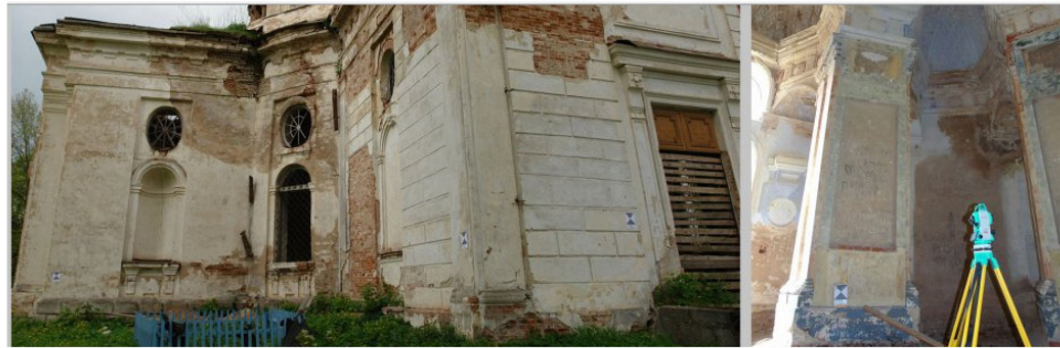
сканирование объекта с помощью лазерного сканера
