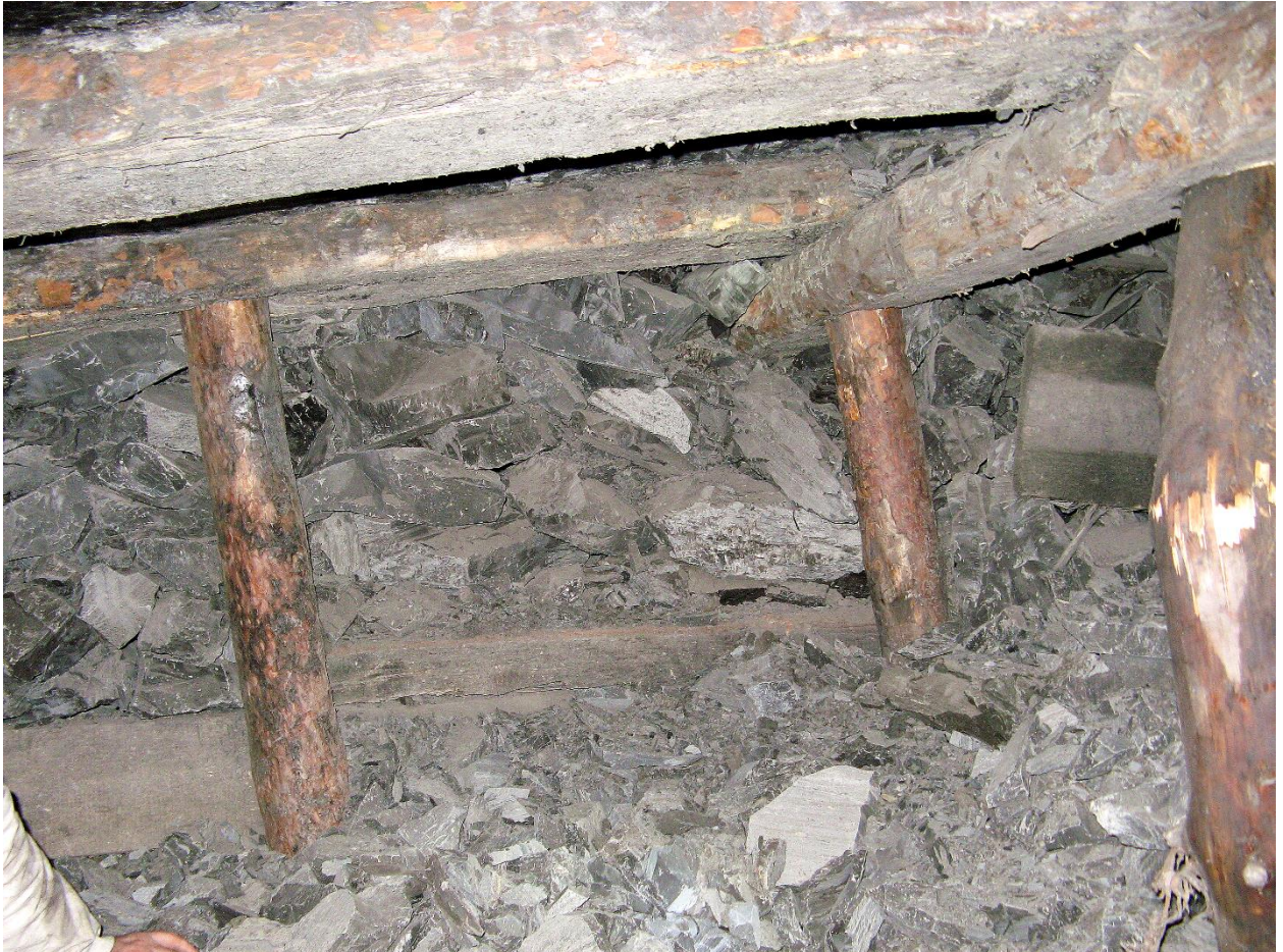
Рисунок 1.9 – Общий вид возводимой вручную бутовой полосы
