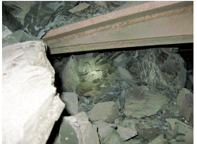
Рисунок 1.10 – Общий вид обрушения пород кровли позади секций крепи с обратной консолью
