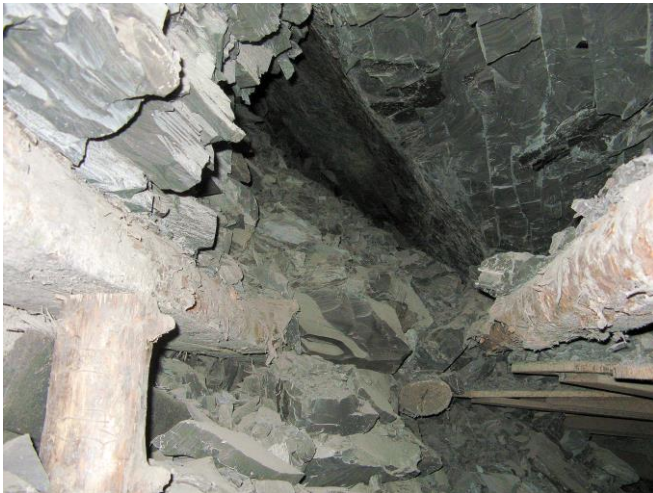
Рисунок 1.10 – Общий вид обрушения пород кровли позади секций крепи с обратной консолью
