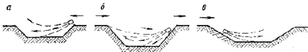
Рис. 24.10 – Схемы вентиляции карьеров вентиляторной установкой
