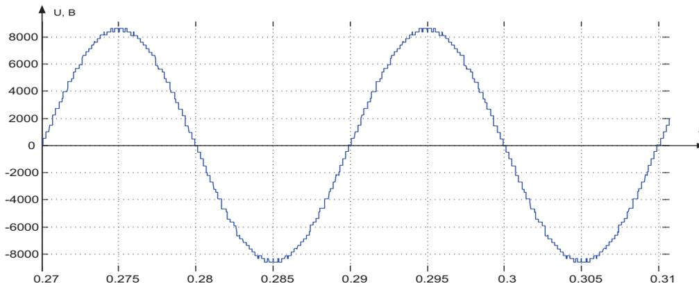
Рисунок 4 – Выходное напряжение одной фазы НКМПЧ
