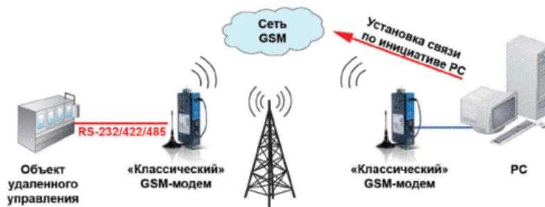
Рисунок 1 - «Классическая» топология системы удаленного управления оборудованием по сетям GSM
