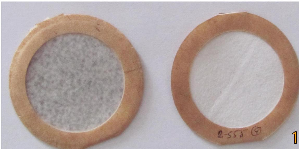
Рис. 1 – Внешний вид фильтра, после прокачки через него воздуха в контролируемом рабочем месте (рабочем месте рукоятчика); слева – запыленный фильтр; справа – чистый фильтр.
