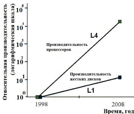
Рисунок 17. – Опережающий рост производительности процессоров (CPU Performance) в соответствии с закономерностью L4 по сравнению с ростом производительности жестких дисков (HDD Performance) в соответствии с закономерностью L1 (показан относительный рост по сравнению с уровнем 1988 года, принятым за единицу); источник [17]
