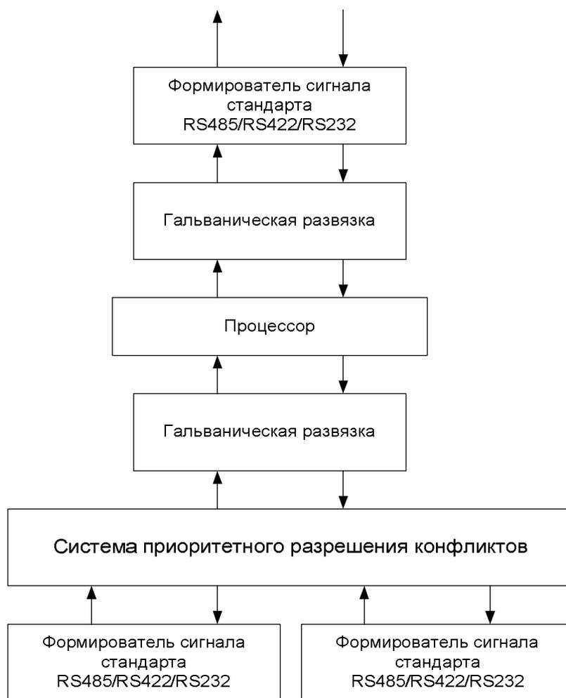
Рис. 2. Функциональная схема интеллектуального преобразователя интерфейсов.
