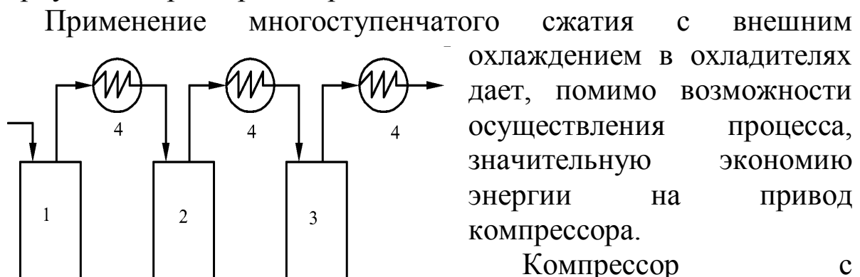
Рисунок 2.21–Схема компрессора со ступенчатым сжатием: 1, 2, 3– ступени, 4 – охладители
