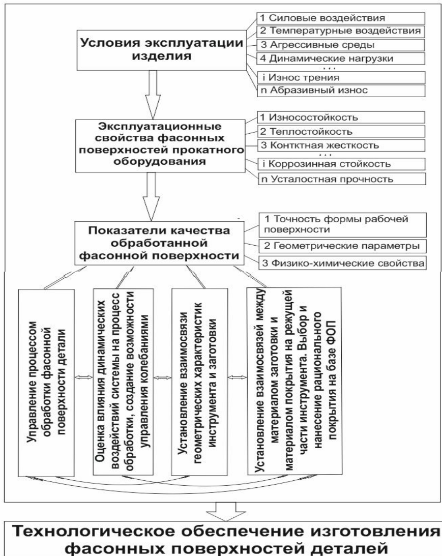
Рис. 2. Структурная схема процесса обеспечения качества фасонных поверхностей деталей прокатного оборудования
