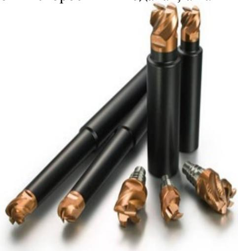
дет к сокращению времени обработки и увеличит долговечность инструмента. Покрытие PowerA позволяет работать на более высоких скоростях, а также при определенных условиях работать без СОЖ. Как и предшественник, покрытие PowerA, целесообразно применять для обработки разрушение твердых и труднообработываемых пород. Твердость: 3800 HV . Толщина покрытия: 2- 4 микрона.
