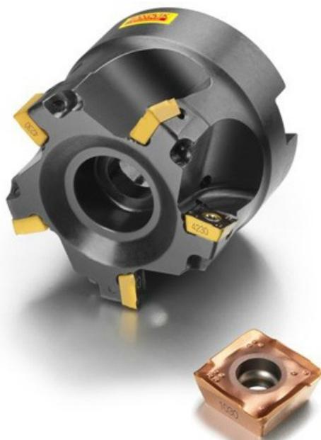
*Нитрид титана (TiN)* - покрытие цвета яркого золота, имеет поверхностную твердость в районе 2800 HV (80HRC), коэффициент трения около 0.5 и тепловую стабильность до 540°C. Увеличивается скорость, повышается износостойкость и долговечность инструмента.
