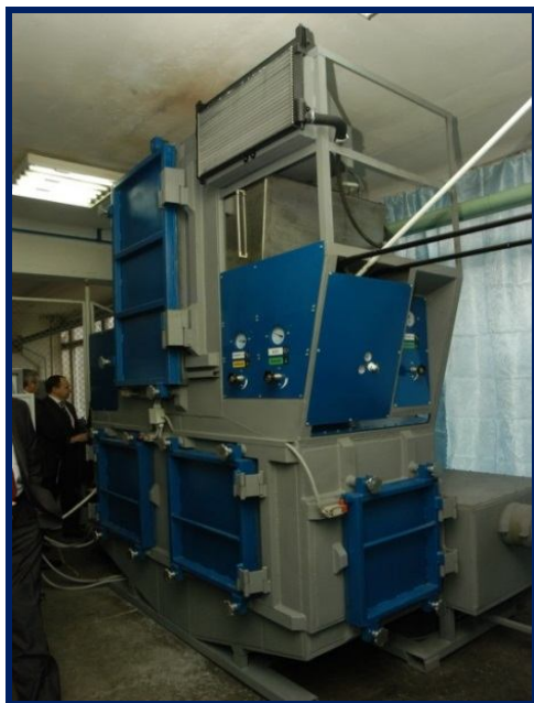
Рис. 12. Детонационная установка для напыления функционально-ориентированных покрытий
