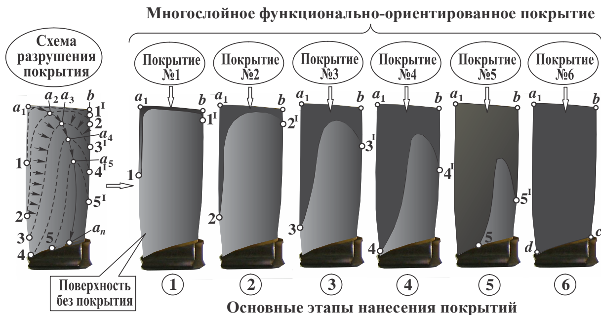
Рис. 11. Схема формирования многослойного ФОП
