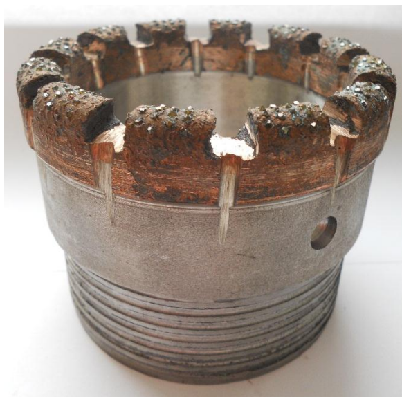
Рис. 2. Опытный образец коронки БСО-1
