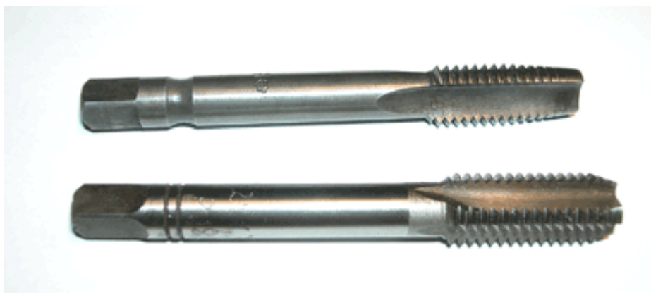
Рис.1. Специальные метчики до нанесения покрытия
