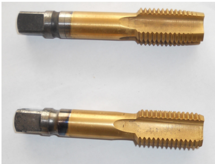
Рис.6 Метчики после нанесения покрытия
