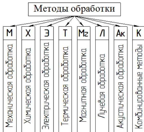
Рис. 1. Классификация методов обработки по виду затрачиваемой энергии
