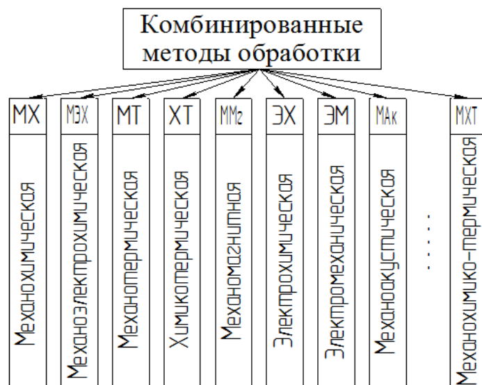
Рис. 2. Классификация комбинированных методов обработки по виду применяемой энергии
