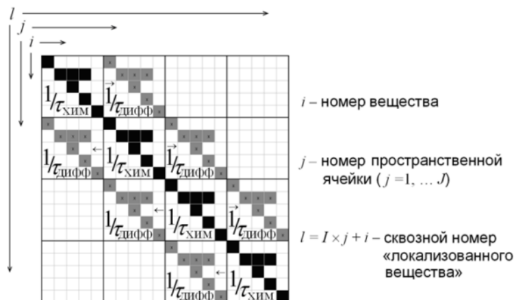
Рис. 2. Структура якобиана в модели внутрицилиндровых процессов ПДВС
