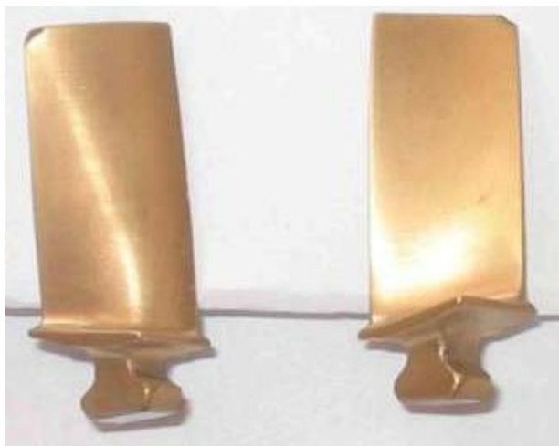
Рис. 2. Покрытие из \text{TiZrN} , нанесенное на лопадки вертолетного двигателя ТВ3-117 в вакууме плазменно-ионным методом
