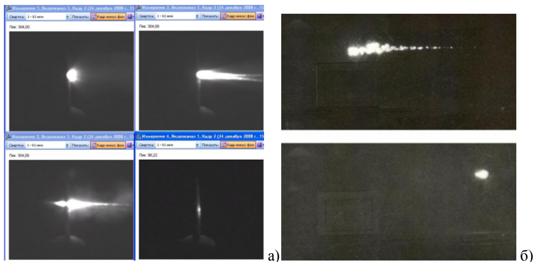
Рис. 1. Кадры регистрации пробивания отверстия лазерным лучом
