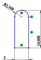
Рис. 2. Упрощенный профиль сечения спирали гибкого тарнспортёра
