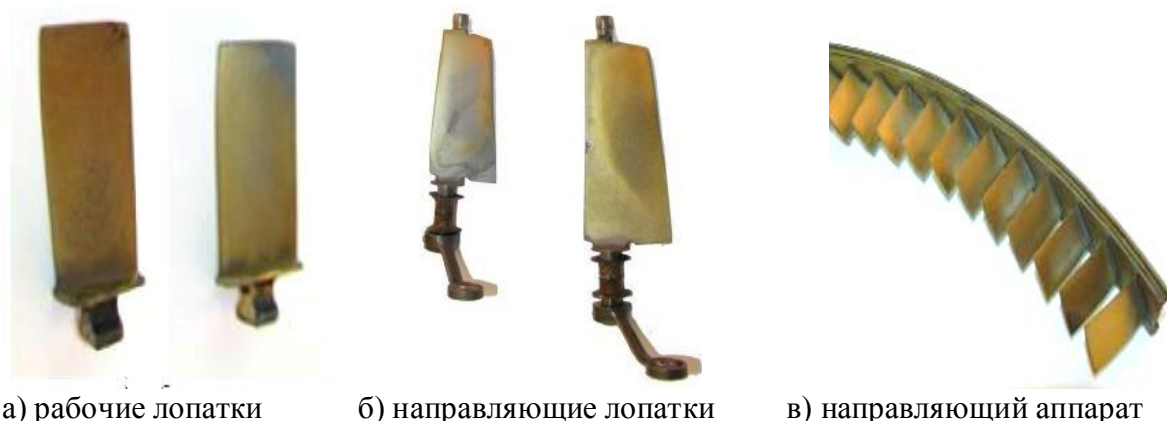
Рис.1. Детали вертолетного двигателя ТВ3-117 с покрытием нитрида титана после эксплуатации в тропическом климате в условиях песочных почв
