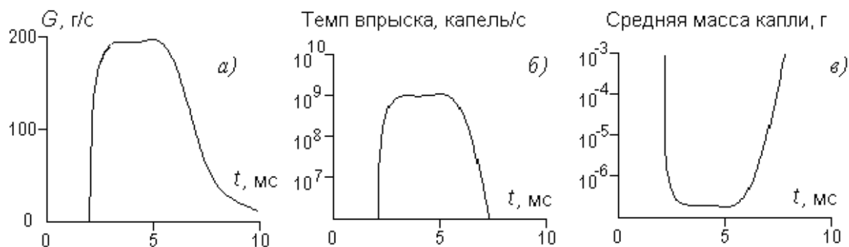
Рис. 1. Количественные характеристики впрыска топлива в тепловозном дизеле: а и б – массовая и «капельная» подача топлива, в – средняя масса капель
