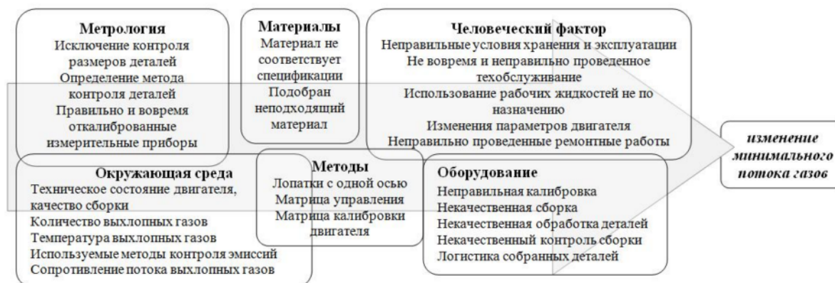
Рис. 3. Причины изменения параметров потока выхлопных газов через VNT
