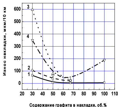
Рисунок 3 - Износ ТН от содержания в ней графита. Скорость движения - 54 км/ч. Плотности тока: 1-0А/см 2 ; 2-35А/см 2 ; 3-70А/см 2 ; 4-100А/см 2 .
