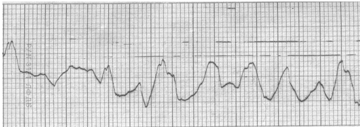
Рис. 1. Пример профилограммы рабочей поверхности эластичного шлифовального бруска
