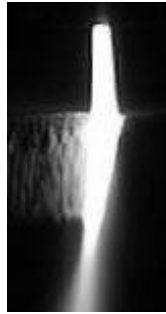
Рис.3. Процесс плазменного нагрева током обратной полярности двухкамерным плазмотроном
