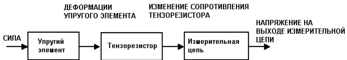
Рис. 2. Структурная схема тензорезисторного датчика силы
