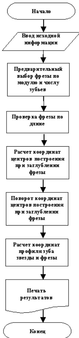
Рис. 2. Блок – схема программы по подбору параметров пальцевой модульной фрезы.
