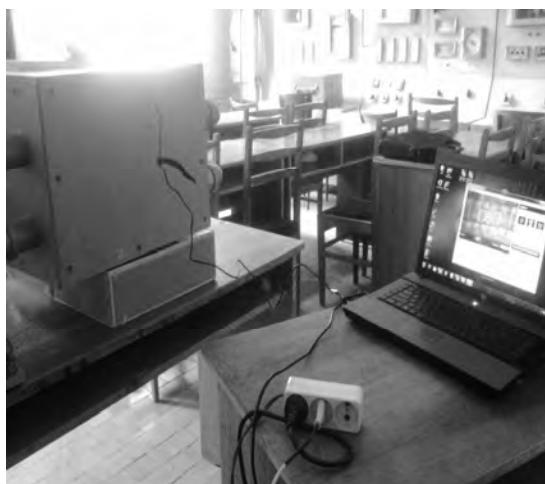
Рисунок 7 – Работа экспериментальной установки камерной печи с видеозаписью при помощи web-камеры
