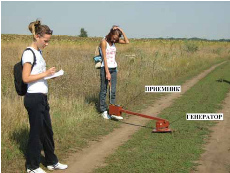
Рис. 1 Полевые съемки прибором ЭФА на поле шахты Засядько
