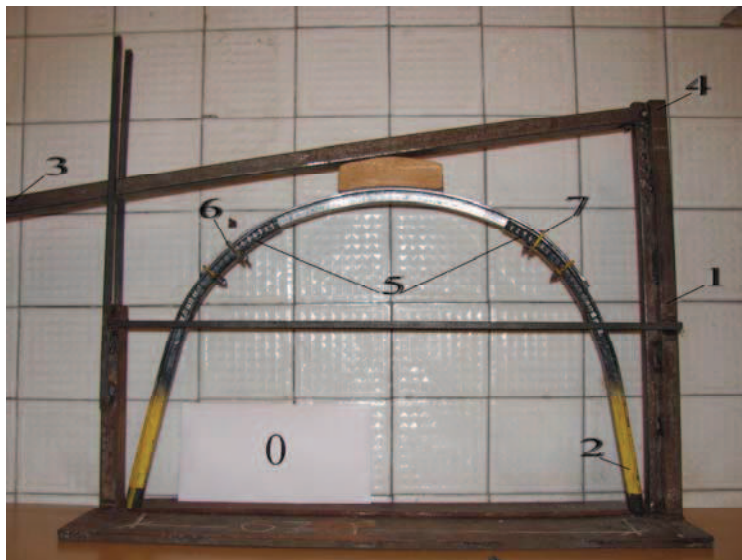
Рис. 2. Стенд для испытаний работоспособности арочной крепи: 1 – пространственная рама; 2 – модель трехзвенной крепи; 3 – нагрузочный рычаг; 4 – место крепления рычага к пространственной раме; 5 – калиброванная шкала в местах соединения несущих элементов крепи; 6 – замок (узел) №1; 7 - замок (узел) №2
