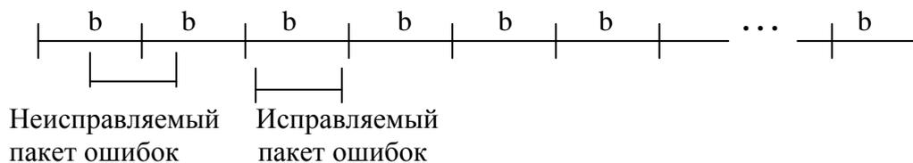
Рисунок 5 - Преобразование триад (символов кода Рида-Соломона) в последовательный код
