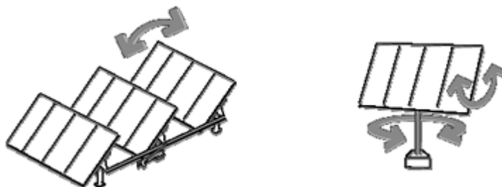
Рисунок 2 - Одноосевые и двухосевые солнечные установки
