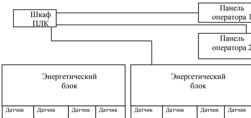
Рисунок 1 – Схема обмена информацией САУ пылеподготовки
