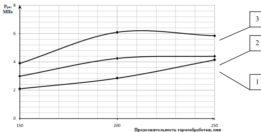
Рис. 1 – Зависимость давления разрушения брикета ( P_{раз} ) с 5 % содержанием опилок от продолжительности термообработки при температурах:
