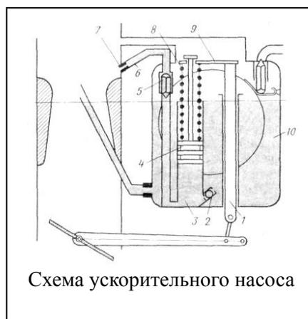
Схема ускорительного насоса
