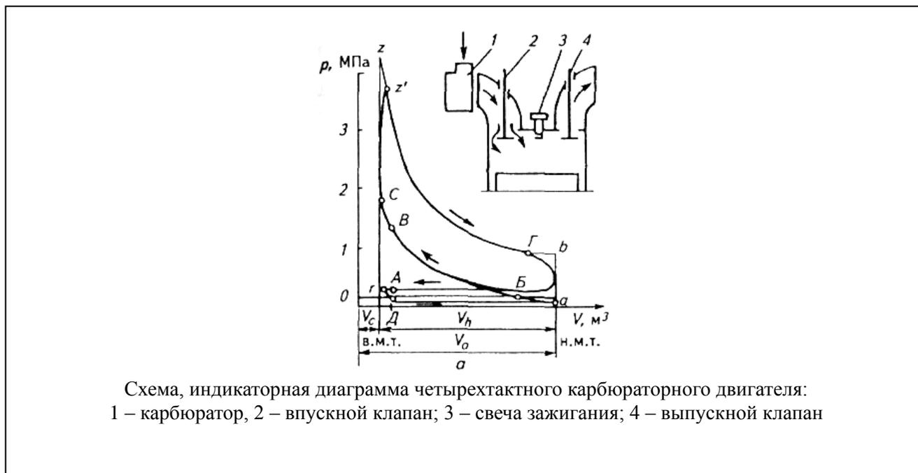
Схема, индикаторная диаграмма четырехтактного карбюраторного двигателя:
