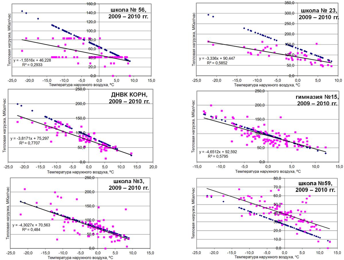
Рисунок 3. – Анализ тепловой нагрузки от температуры окружающей среды зданий:
