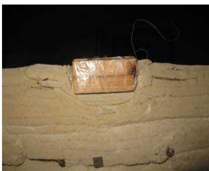
Рисунок 3 — Разрез модели перпендикулярно (а) и параллельно (б) оси выработки
