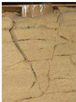
Рисунок 3 — Разрез модели перпендикулярно (а) и параллельно (б) оси выработки
