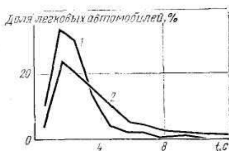
Рис. 2.9. Распределение временных интервалов при различном составе движения ( N = 3100 авт/ч на трехполосной проезжей части):
