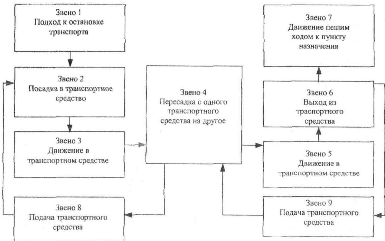
Рис. 3. Технологическая схема передвижения пассажиров несколькими видами транспорта
