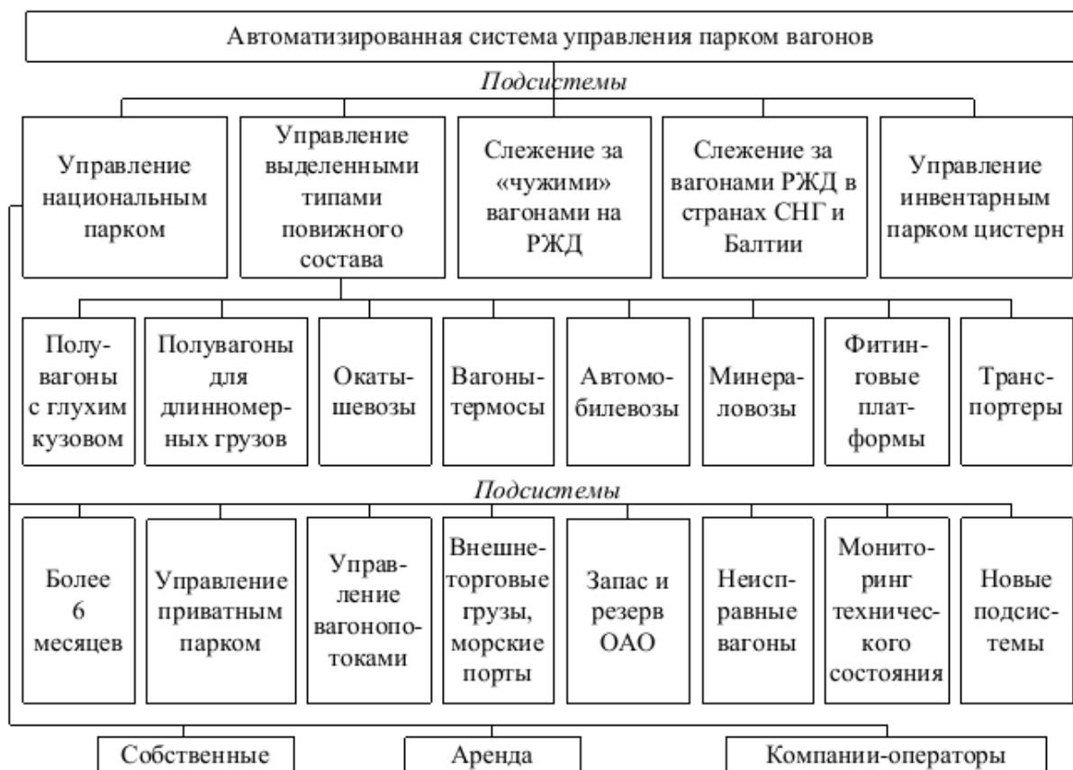
Рис. 9.5. Схема функциональной структуры автоматизированной системы управления вагонным парком
