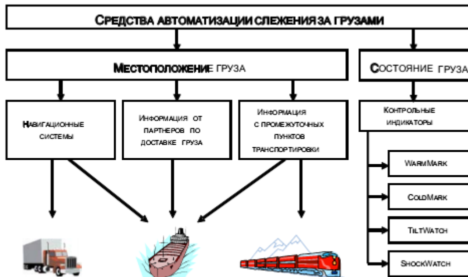
Рис. 5.4. Схема использования средств автоматизации слежения за грузами на транспорте
