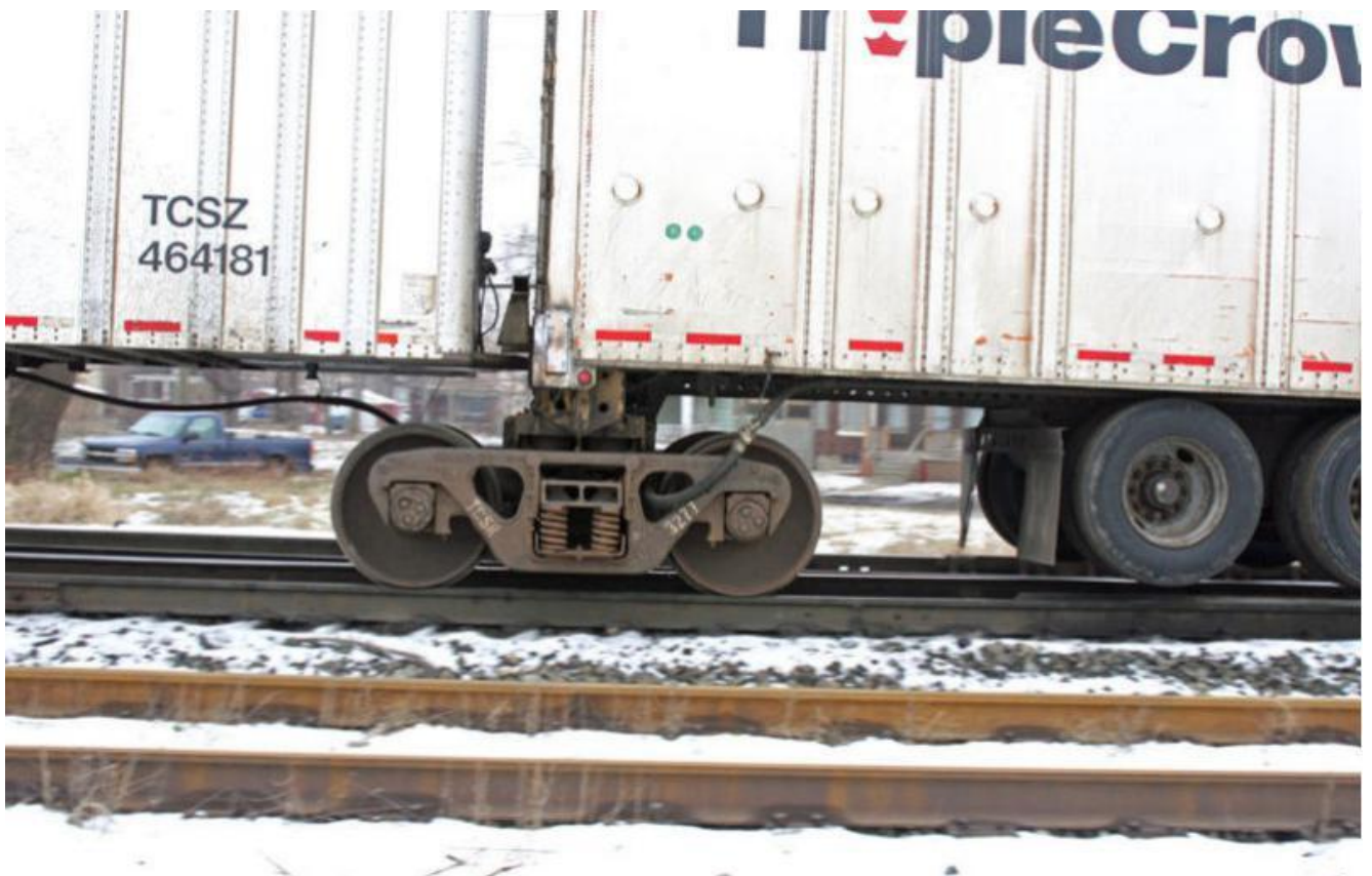
Вагонная тележка системы RoadRailer
