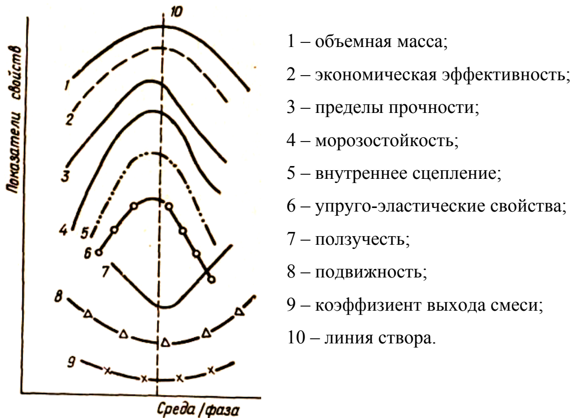
Рисунок 2.4 – Зависимость свойств конгломерата от фазового отношения и содержания вяжущего вещества
