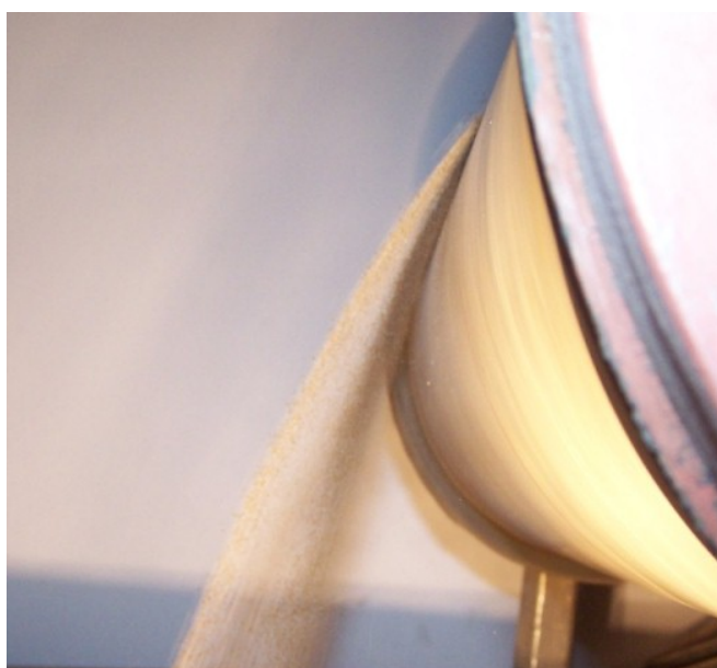
Рис. 6 – Результат фотосъемки опытов по сухому магнитному обогащению зернистых марганцевых шламов с фиксацией угла
