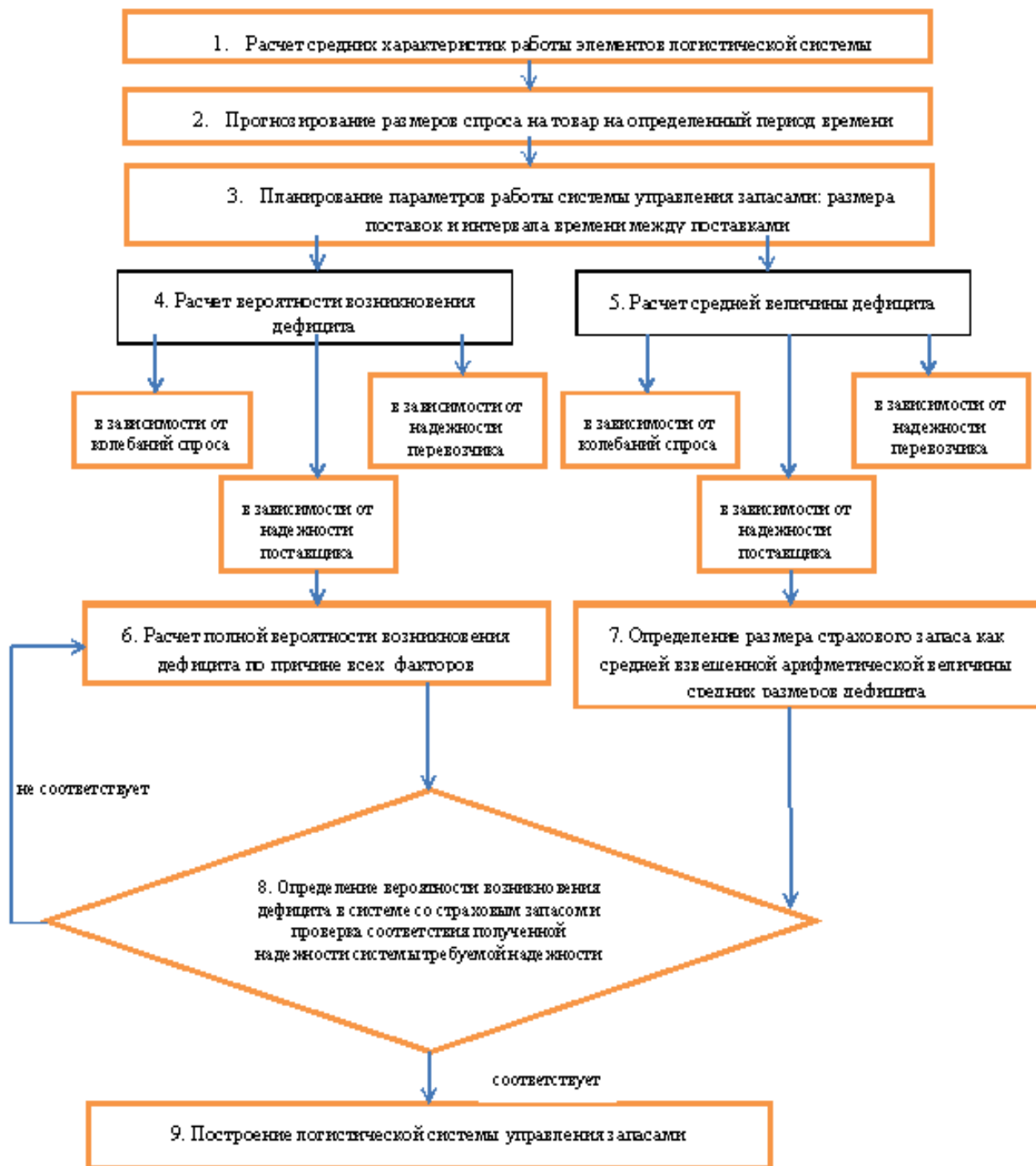
Рисунок 1 – Схема определения надежности функционирования логистической системы и размер страхового запаса в ней
