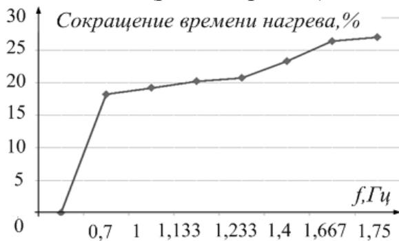
Рис. 12. Время нагрева заготовок в КП при вариации частоты пульсаций
