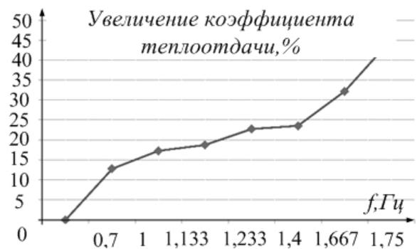
Рис. 13. Коэффициент конвективной теплоотдачи при вариации частоты пульсаций
