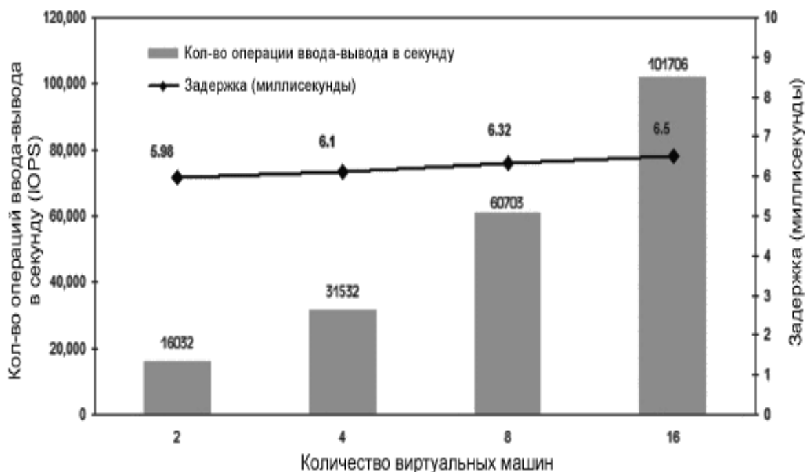
Рисунок 3 — Зависимость характеристик взаимодействия с жестким диском от количества одновременно-запущенных виртуальных машин [11]
