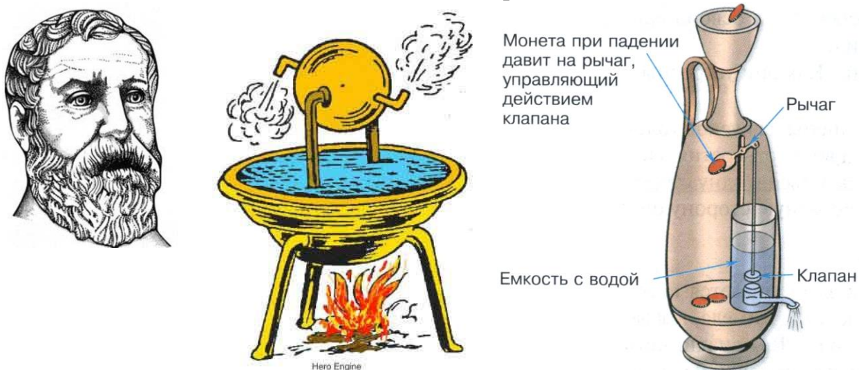
Рис.1.18 – Герон и его хитроумные изобретения: паровая машина, автомат для воды
