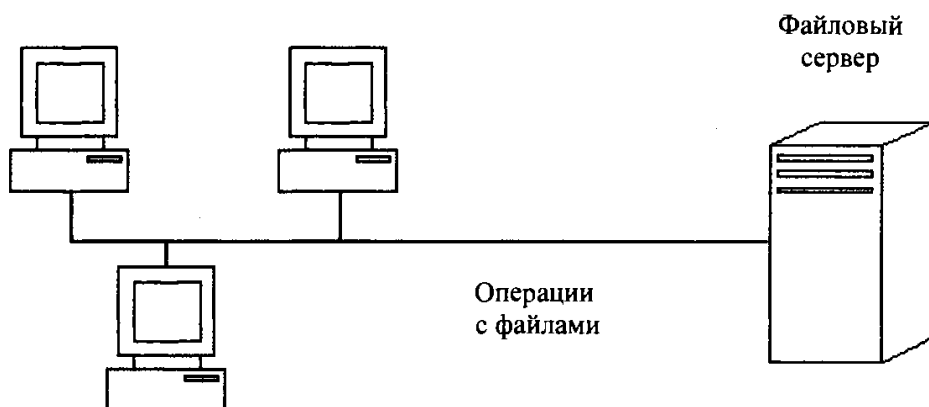
Рис. 1 Модель технологии файл-сервер
