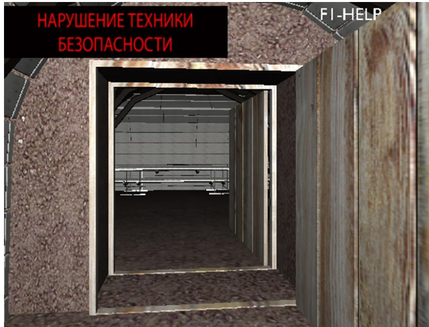
Рис. 2 – Реализация обучающего сценария в ознакомительном режиме с фиксацией нарушений правил безопасности (в данном случае: одновременное открытие нескольких дверей в вентиляционном шлюзе)
