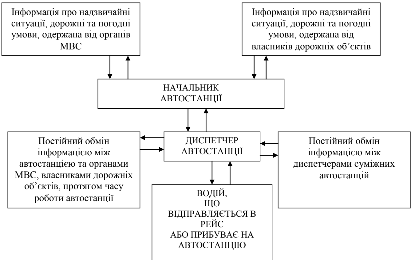
Рис. 30. Схема повідомлення водіїв на автостанції про надзвичайні ситуації, дорожні та погодні умови
